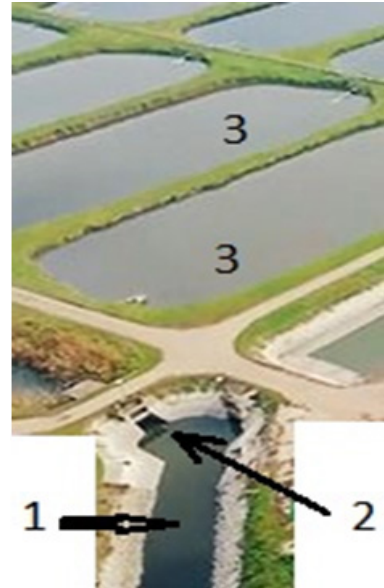
Slika 122. 1 - Dovodni kanal, 2 - upust u napojni kanal, 3 - pojedinačni bazeni
