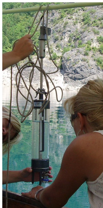
Slika 20. Uzorkovanje Fidingerovom flašom
