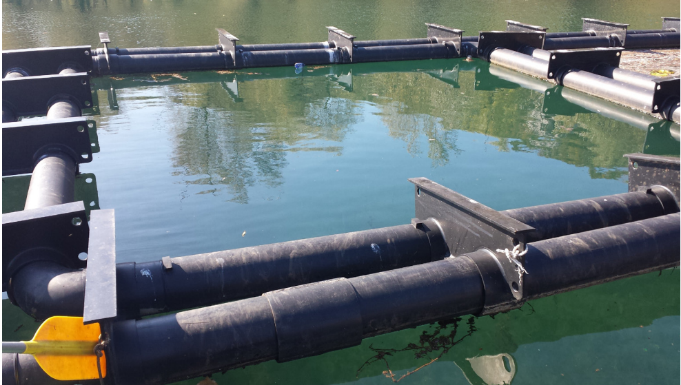
Slika 133. Izgled nosećih konstrukcija kaveza koji je spojen u bateriji
